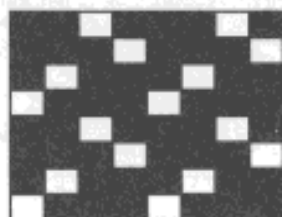
4-tråders brutt kyperbinding med synlige varptråder på rettsiden
